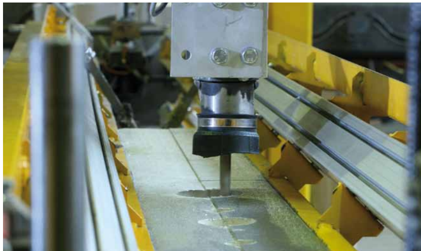
Passgenaue Herstellung von Isolierteilen auf CNC-Fräsanlagen Accurately fitting manufacture of insulating parts on CNC milling units
